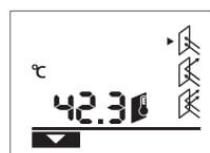
Pro změnu do režimu měření povrchové teploty stiskněte tlačítko režimu měření povrchové teploty **11**. Na displeji se pro potvrzení zobrazí ukazatel **k**.
