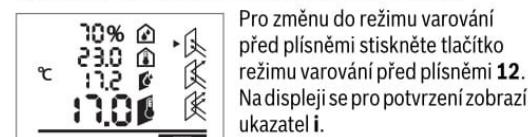
Pro změnu do režimu varování před plísňemi stiskněte tlačítko režimu varování před plísňemi **12**. Na displeji se pro potvrzení zobrazí ukazatel **i**.
